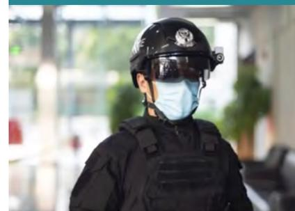
agente di polizia provvisto di elmetto smart con termocamera e head-up display
